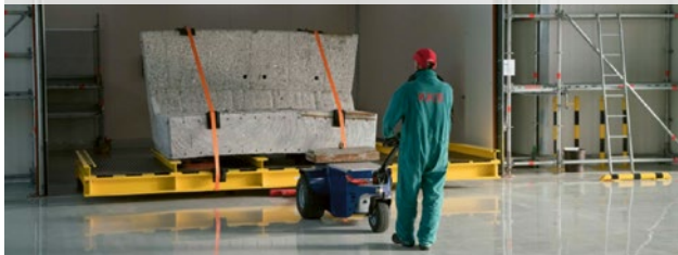
Transport eines Betonsegments zur weiteren Bearbeitung und anschließenden Freigabe
