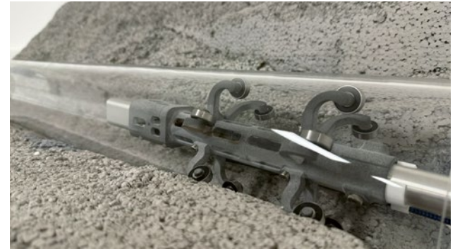
Der „Gammamolch“ im Modell: rechts das rollengelagerte Führungssystem, links die Rohrsonde
