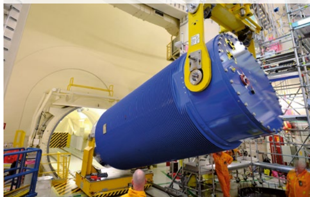
Ausschleusen eines CASTOR®-Behälters aus dem Kontrollbereich
