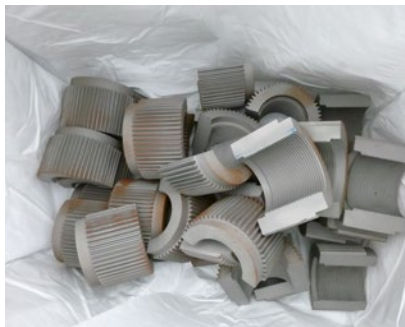
Blick in ein Big Bag mit Metallschrotten; hier Teile von großen Muttern
