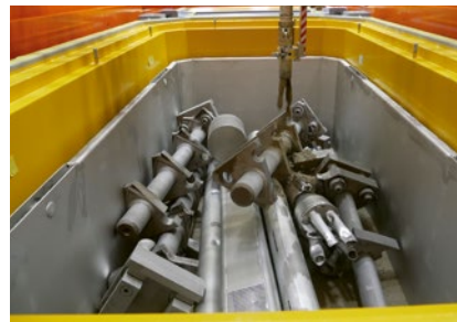
Blick ins Innere eines Konrad-Containers während des Betonierprozesses
