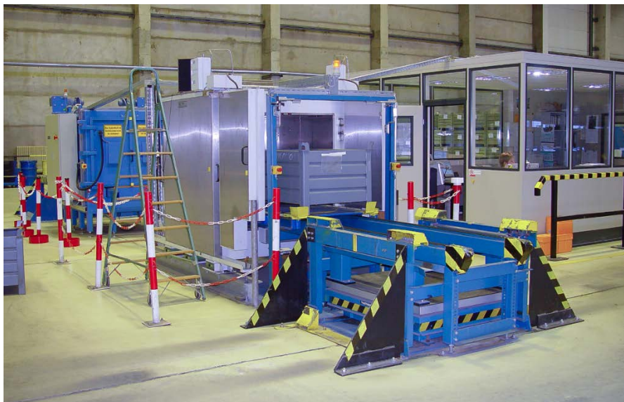
Abbildung 11: Entscheidungsmessung von Komponenten in der Freimessanlage mit allseitig angeordneten Detektoren (EWN Entsorgungswerk für Nuklearanlagen GmbH, Kernkraftwerk Greifswald)
