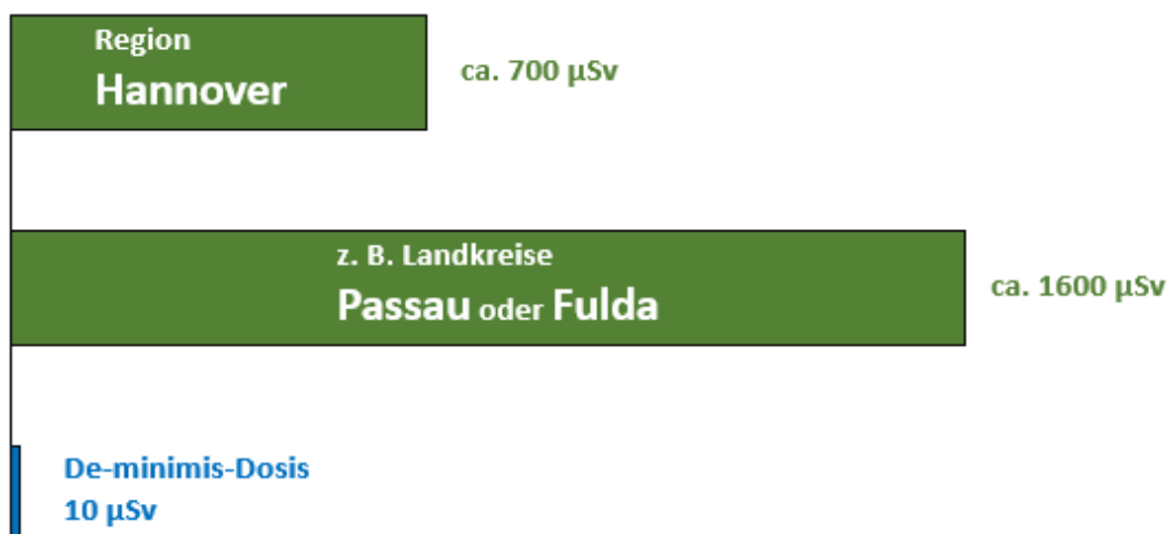
Abbildung 2: Abschätzung des durchschnittlichen Beitrags zur mittleren jährlichen natürlichen Dosis durch Radon in Wohnungen (auf Basis der Werte der Radon-Konzentrationen aus Menzler S., Schaffrath R. A., Wichmann H. E., Kreienbrock L.: Abschätzung des attributablen Lungenkrebsrisikos in Deutschland durch Radon in Wohnungen. Landsberg/Lech: Ecomed Verlag 2006)
