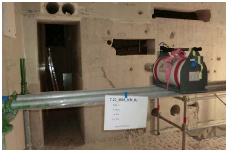
Abbildung 10: In-situ-Gammaspektrometer bei der Entscheidungsmessung von Gebäuden (Brenk Systemplanung GmbH)
