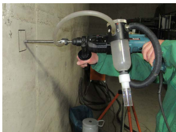
Abbildung 7: Bohrmehlprobenahme, Kernkraftwerk Greifswald (EWN Entsorgungswerk für Nuklearanlagen GmbH, Kernkraftwerk Greifswald)
